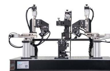
依照實際需求可搭配不同模組與治具，以機器視覺輔助初始化校正，配合多種搜尋演算法實現精準快速的對位需求。
