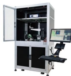
依照實際需求可搭配不同模組與治具，並適用於不同切面角度的光纖，進行高效率演算，生成掃描的軌跡以及點位的插補，達成精準快速的對位目標。
