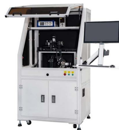
手、電動精密滑台模組搭配自主開發光纖陣列耦合軟體，將耦合精度與速度，提升到最佳條件。
