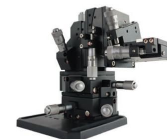
緊湊的機構設計，可達到穩定的高精度，最小分辨率可達0.5μm。適用在光通訊-光纖器件耦合作業場合。
