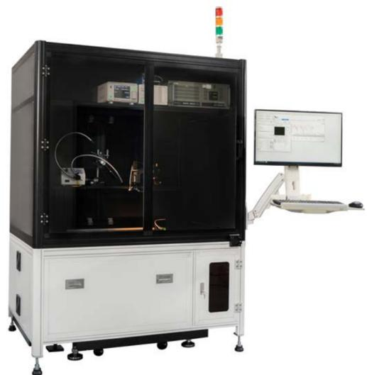
光路耦合為矽光晶圓檢測中一個流程，矽光晶圓檢測須將光纖對準晶圓上之光路，以利後續光譜分析及檢測光路特性。本系統可做為耦合系統，確保檢測一致性。
